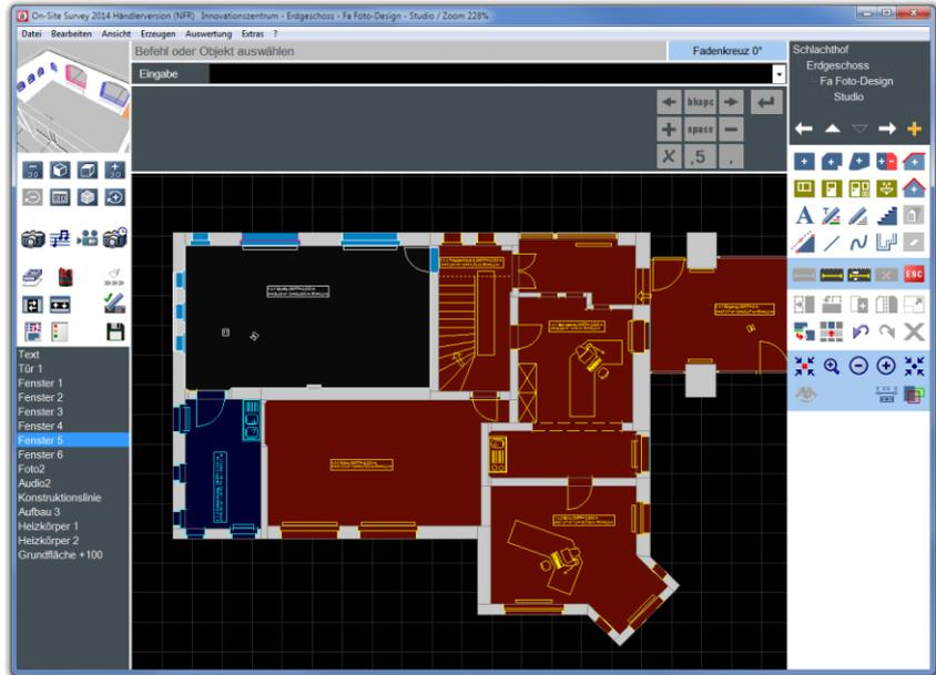
**On-Site Survey** bietet ein optionales Modul zur direkten Nutzung des Leica 3D-Disto. Dieses Modul ist ideal für komplizierte Grundrisse und höhere Anforderungen an die Messgenauigkeit und den Messbereich.
